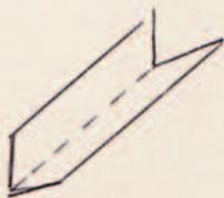
DIE TEILE 1 BIS 6 WERDEN EINZELN DER LÄNGE NACH MIT DER SILBERSEITE NACH INNEN GEKNICKT UND GEFALZT.
